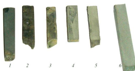
Рис.1. Фотографии образцов керамики SiC-AlN, полученные методами электроимпульсного и высокотемпературного спекания.
