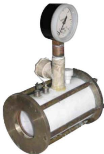
Установка локальной очистки сточных вод
